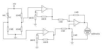
De acordo com o manual do fabricante do sensor NTC, para uma temperatura de 30  $^{\circ}$ C é observada uma resistência de 8 k $\Omega$  portanto, o valor da tensão exibida na tela (display) do voltímetro ligado na saída do circuito eletrônico apresentado é de:
